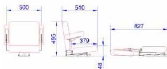
Figure 191 : dimensions d'un siège télescopique
