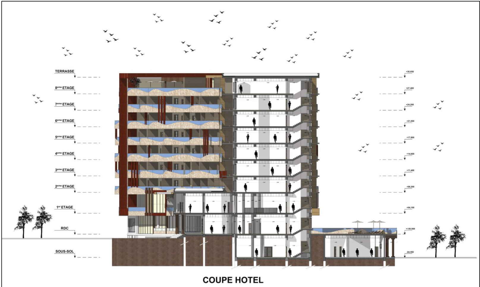
Figure 129: coupe détail de l'hôtel. Source : les auteurs
