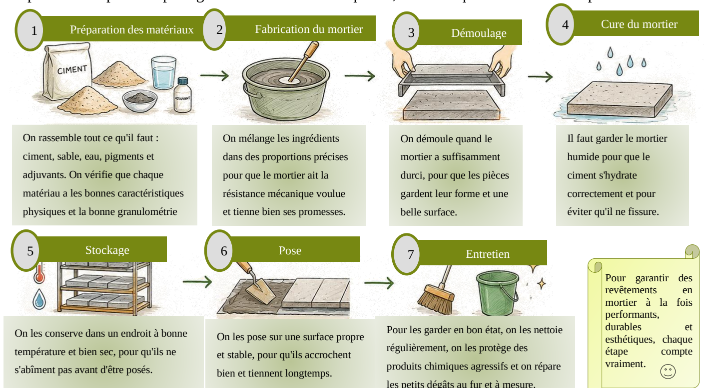
Figure 12: Méthode de fabrication du mortier de revêtement.
