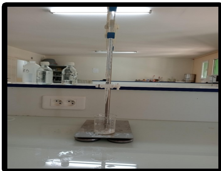
Figure 8 : Mesure l'acidité par titration
