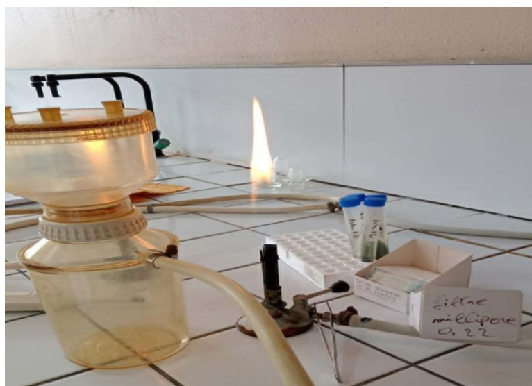
Figure 10 : Système de filtration par une pompe à vide
