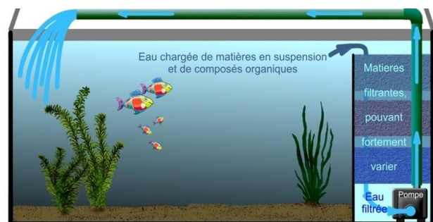
Fig148. schéma de principe du système de filtration d'un aquarium
