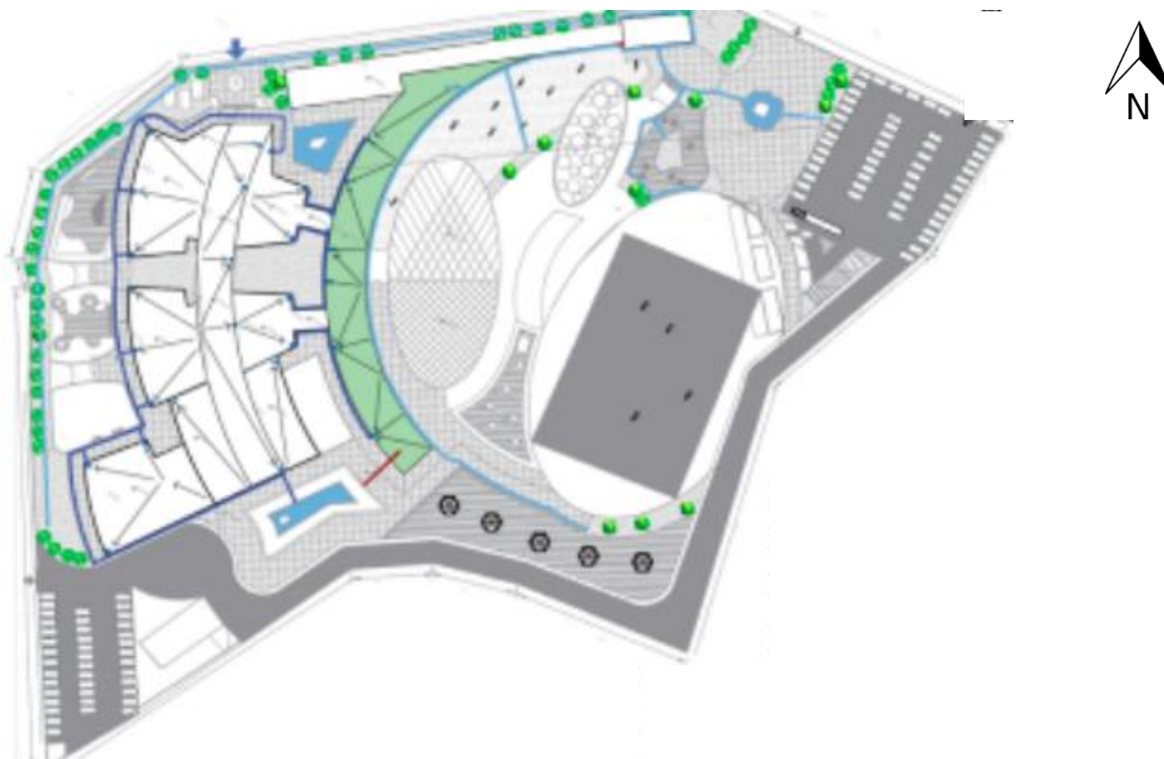
Planche 23: récupération des eaux pluviales; Source : auteurs
