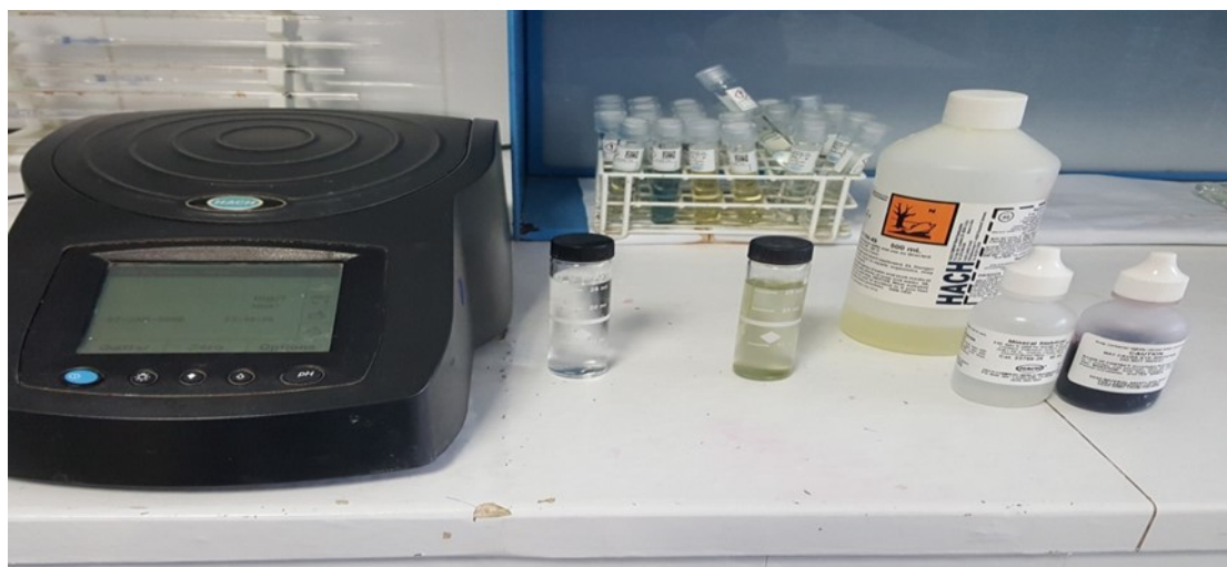
Figure 20 : dosage de l'ammonium (NH 4 + )
