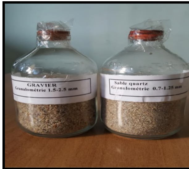
Figure 13 : Gravier et sable quartz utilisé dans la filtre à sable
