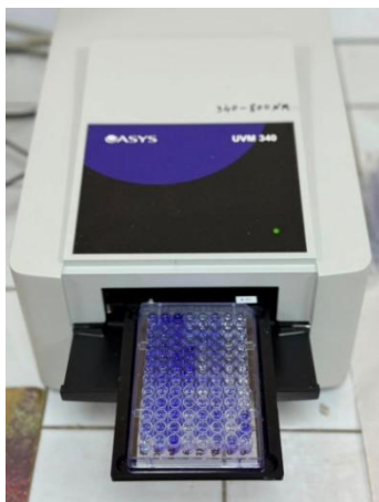
Figure 11: lecteur automatique de microplaque à une absorbance à 596 nm
