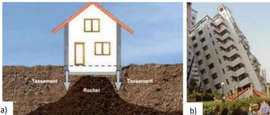
Figure 1-4: Mécanisme de tassement du sol (a) et cas d'exemple de la conséquence du tassement du sol sous un bâtiment (b).[3]
