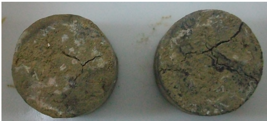
Figure. 27. Exemple de présence de fissures durant l'humidification.
