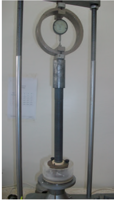
Figure. 5-7. Compactage quasi statique pour essais œdométriques.
