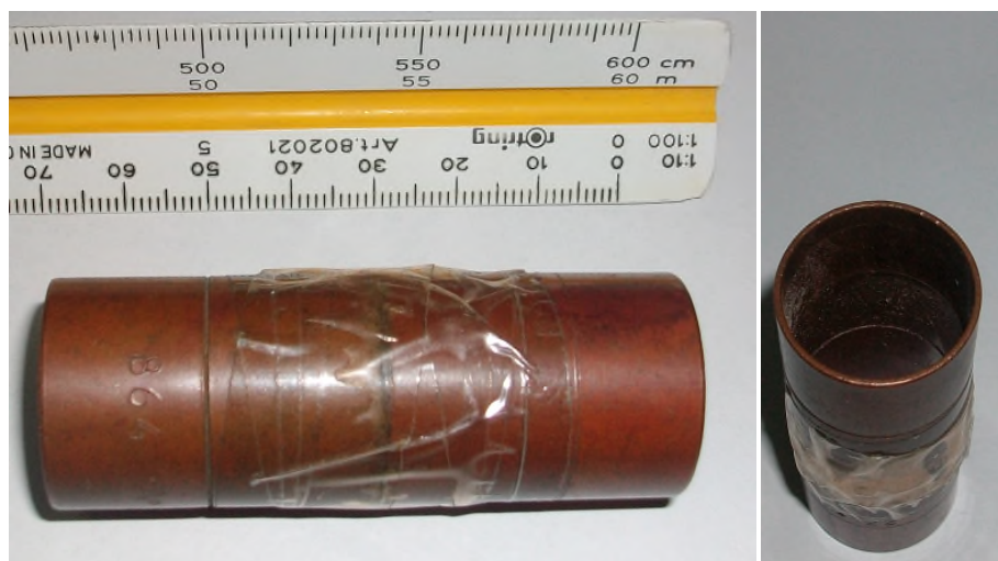
Figure. 5-8. Moule de compactage pour un essai de drainage humidification.
