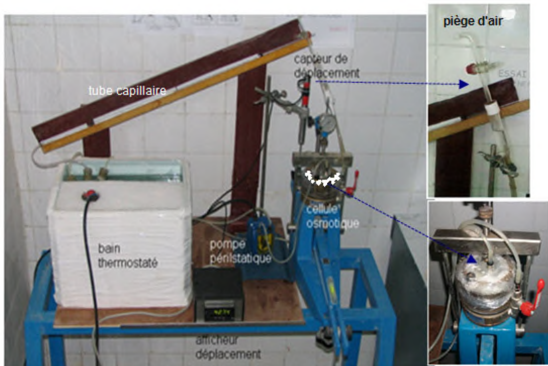
Figure. 4-9. Vue d'ensemble d'un essai œdométrique utilisant la cellule osmotique à double échange.
