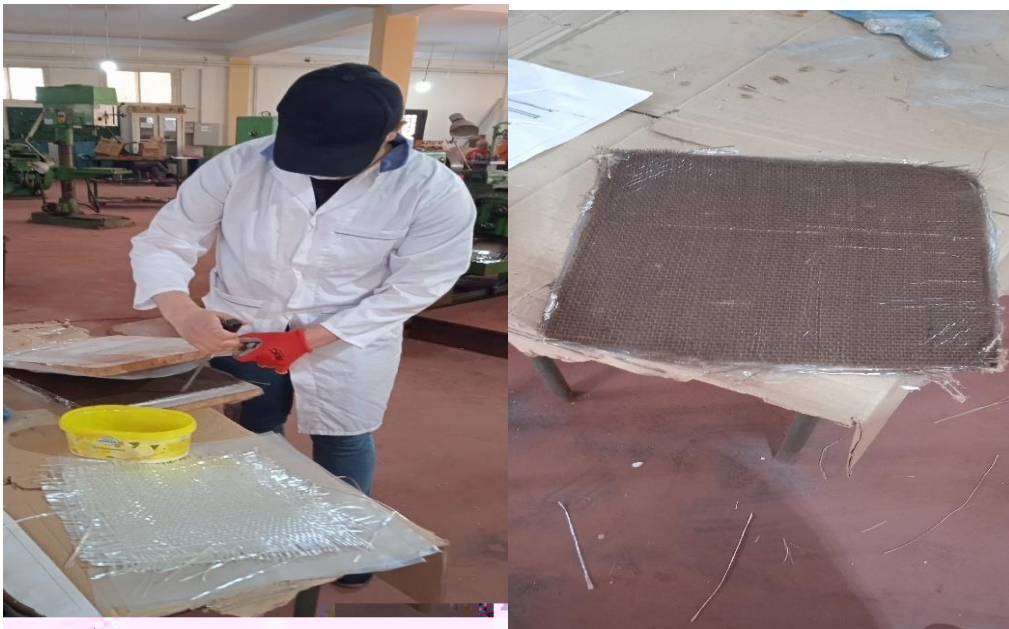
Figure II-11 : Le processus d'ouverture du moule et d'extraction de la plaque
