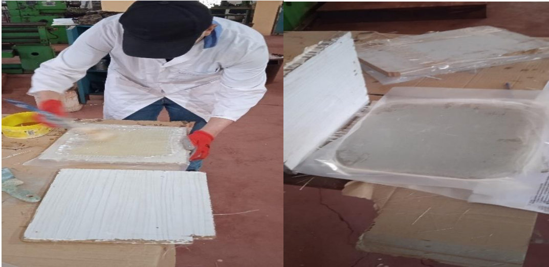
Figure II-12 : Préparation du MAT de verre et roving
