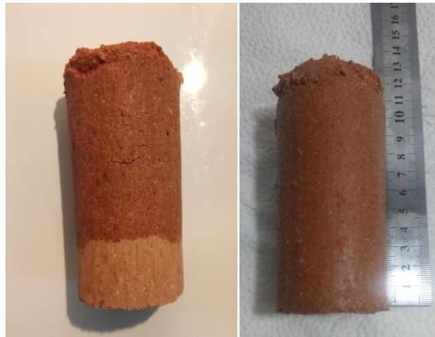
Figure. III. 14. Effritement de la base de l'échantillon au contact avec l'eau.
