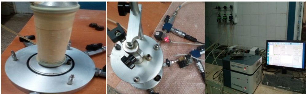
(a)Montage de l'échantillon (b) La cellule triaxial (c) Centrale d'acquisition Figure. III. 19. Mesure de la conductivité hydraulique saturée (dispositif triaxial).
