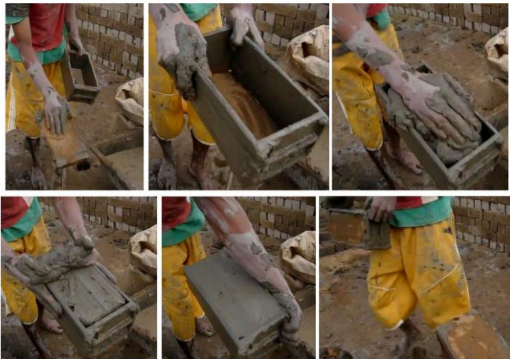
Figure. I. 14. Image de fabrication d'adobe. ( https://associationlevillage.fr )
