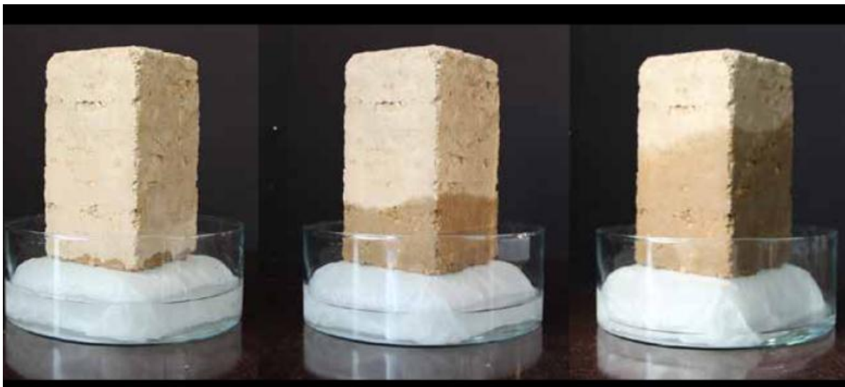
Figure. II. 19. Essai de capillarité sur des blocs de pisé. ( Couvreur, 2014 ).
