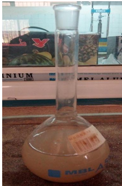
Figure. III. 6. Détermination du poids volumique des grains solides par le pycnomètre (500ml).
