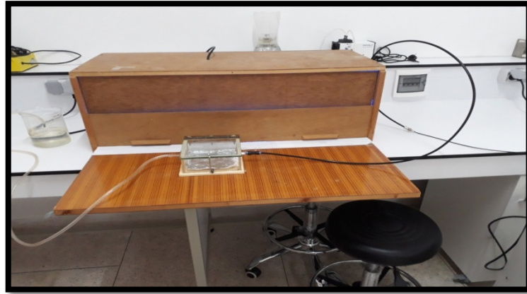
Figure 04 : Dispositif de photo polymérisation par rayon UV
