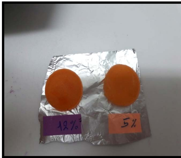
Figure 17: Rétention et gonflement de la pastille avec une solution colorée d'Orange de telon
