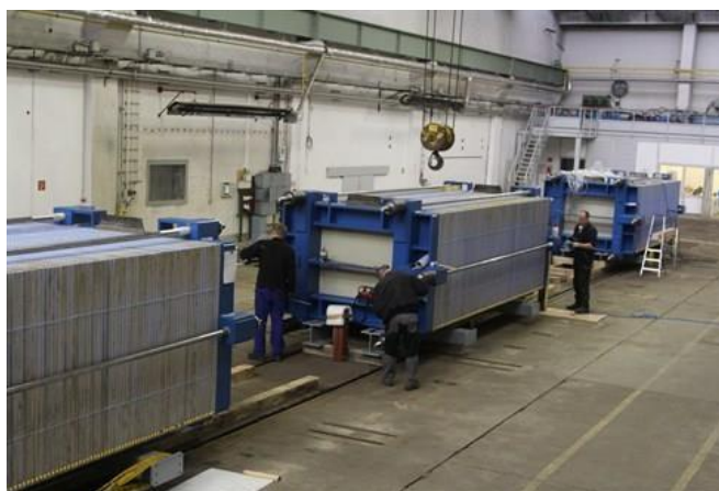
Figure 3.4. Trois unités d'électrolyseur alcalin Enertrag de 2 MW unitaire – 1000 m 3 /h
