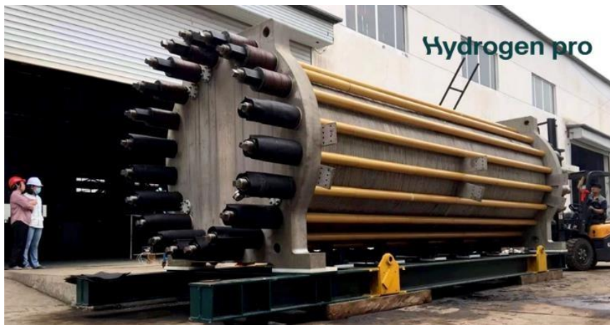
Figure 3.24. L'électrolyseur Hydrogen PRO de 1 100 Nm 3 /h (2022)
