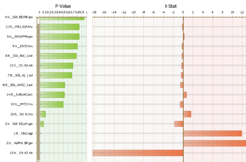
Figure VI.1 : Résultat de l'analyse de sensibilité globale (SUFI-2) : Classement des paramètres SWAT par influence (t-Stat) et significativité (P-Value).
