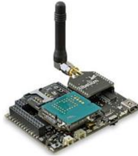
Figure 1.1 - Exemple d'un capteur sans fil [2]
