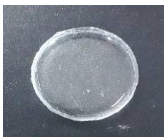
Figure II. 11: Réseau de copolymère élaboré par photo-polymérisation.
