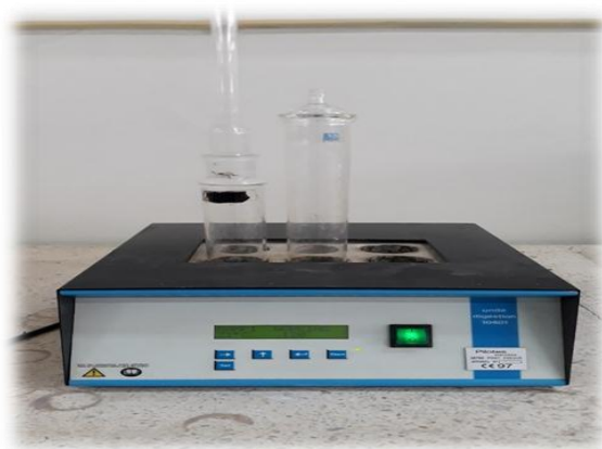
Photo IV. 23: Digesteur (réacteur DCO pour le chauffage)
