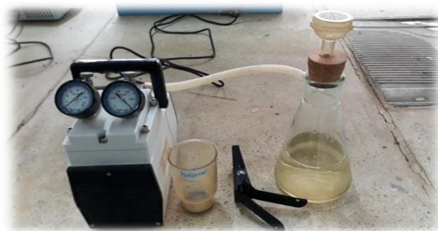
Photo IV.20: Dispositif de filtration
