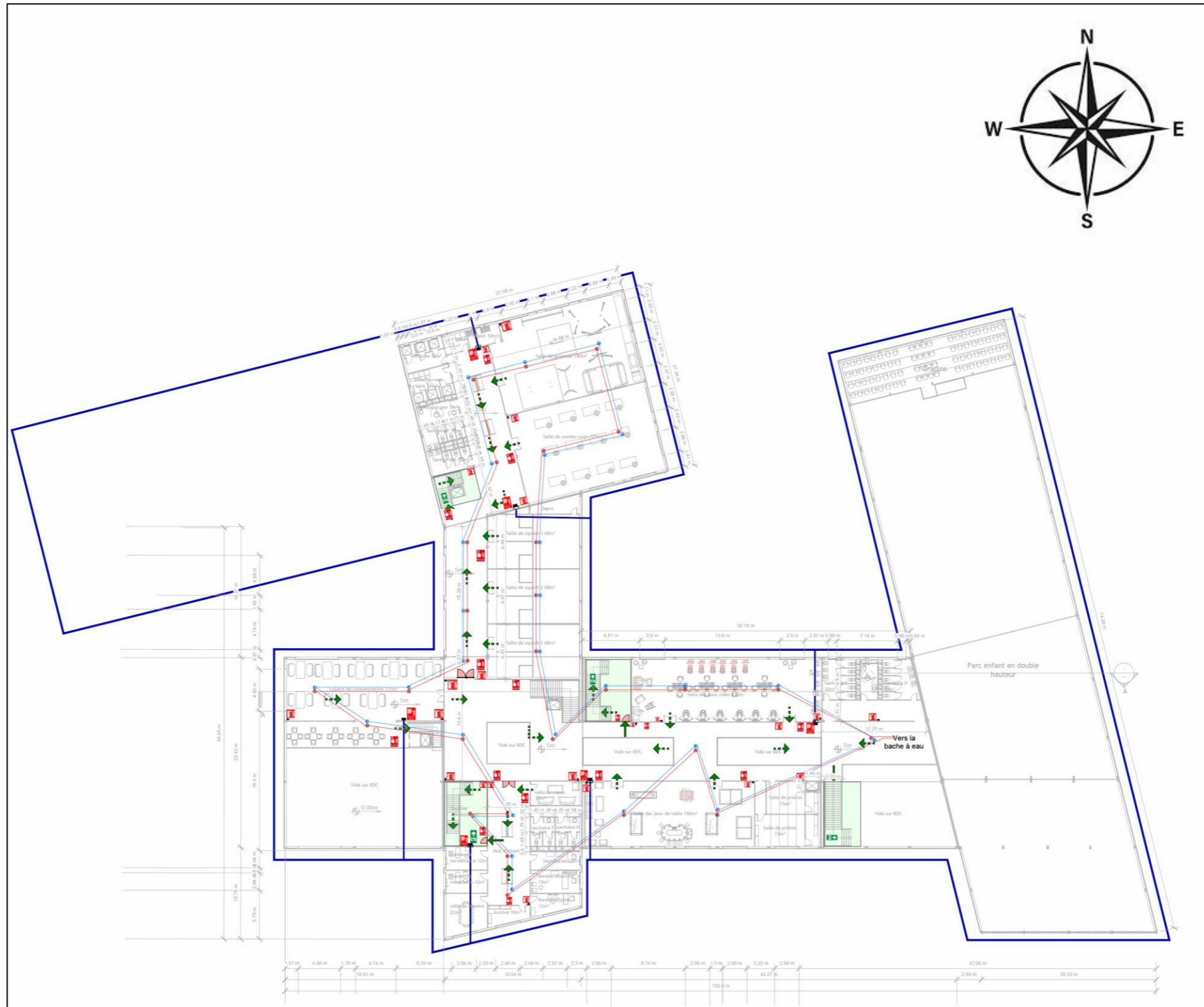
Figure 170 : Plan du réseau anti incendie « premier étage »
