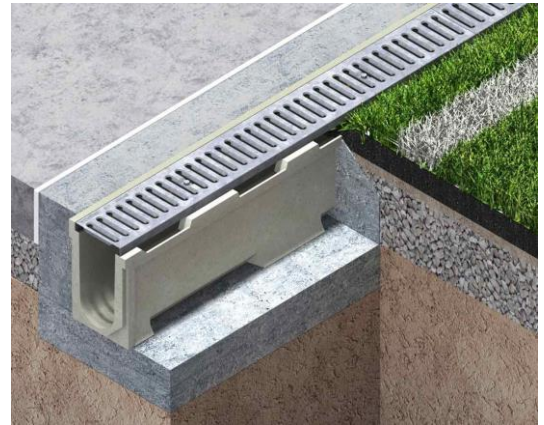
Figure 124 : Caniveaux drainage à le stade.
