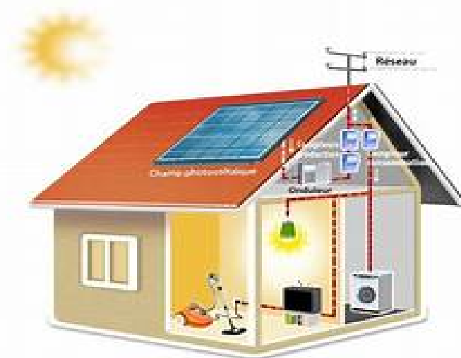
FIGURE I.1 – Système solaire photovoltaïque [54]
