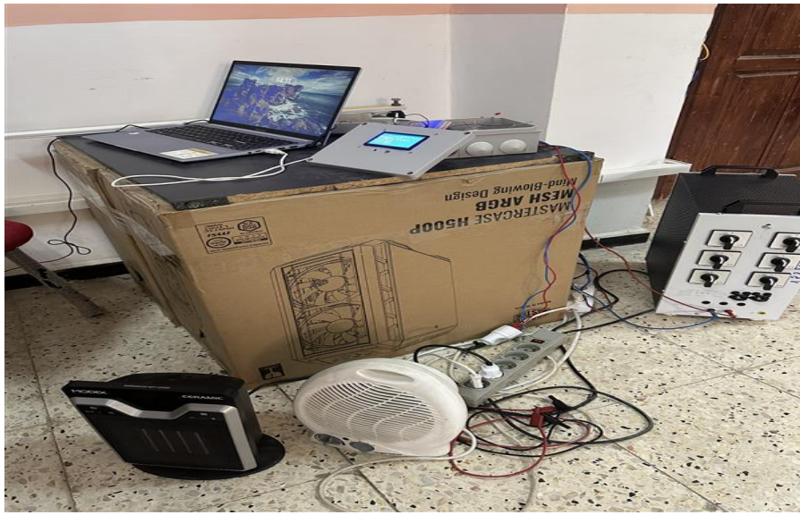
Figure IV.8:Montage de Roteur solaire
