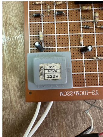
FIGURE II.1 – Transformateur abaisseur de tension 230 V / 6 V
