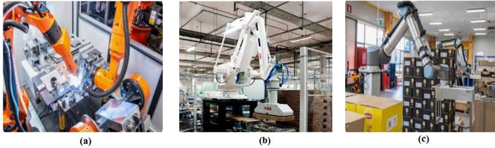
FIG. 1.3 : Bras manipulateur industriel. (a) KUKA KR QUANTEC, (b) ABB IRB 6700, (c) Universal Robots UR10e.
