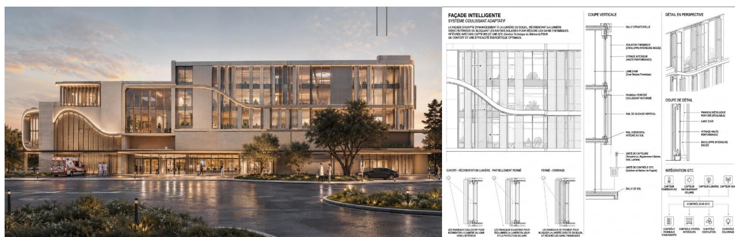
Figure 87 : système de façade double peau
