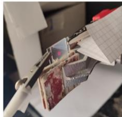
Cellule PDLC soumise à un champ électrique
