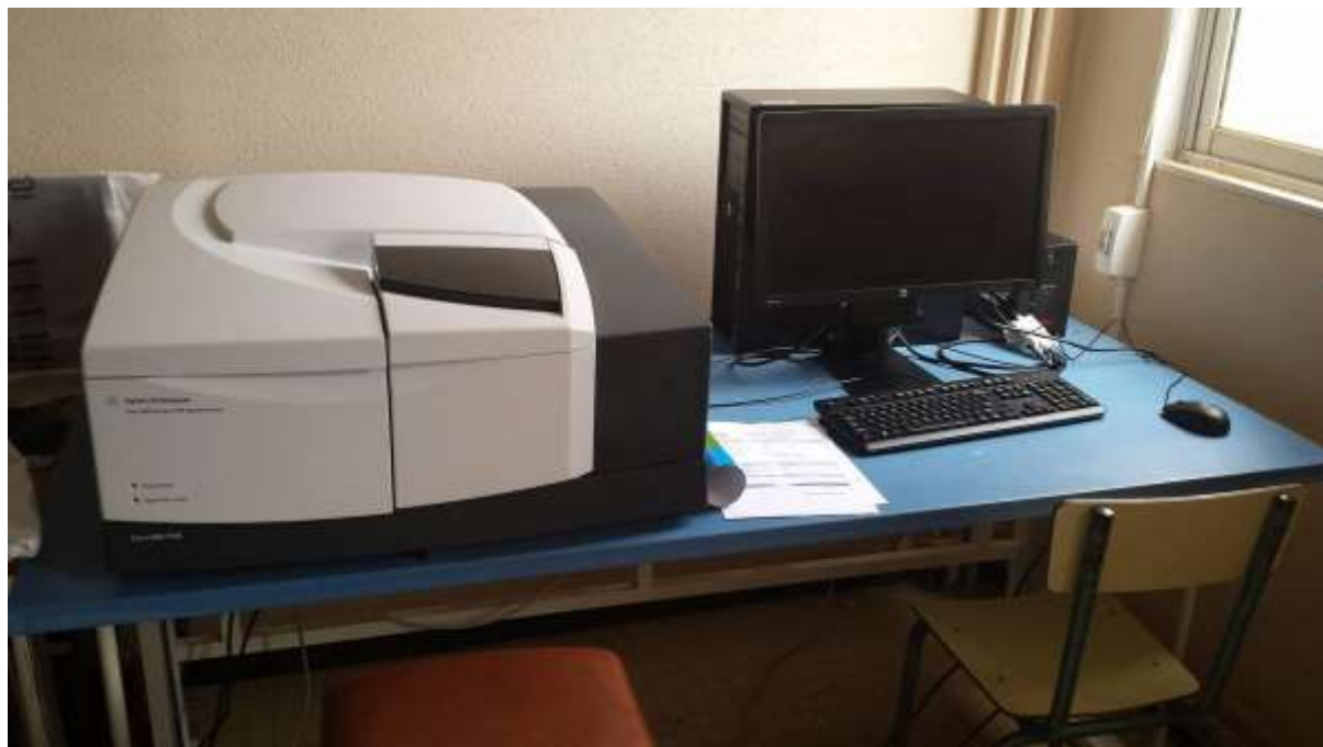
Figure II.2 : L'équipement infrarouge "CARY 600 SEIES FTIR" (LAEPO)
