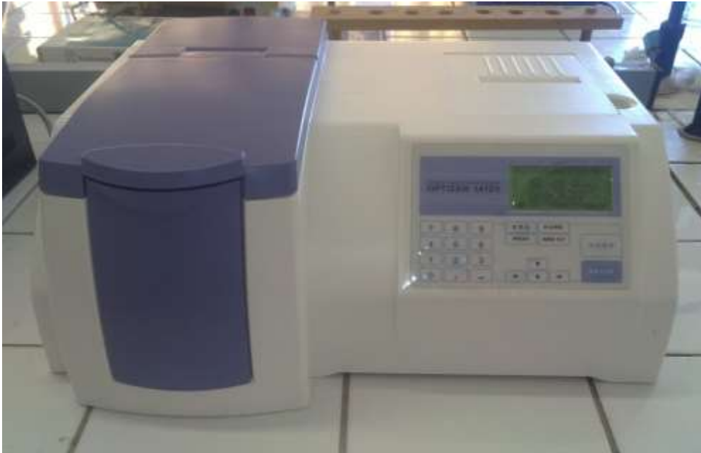
Figure II.3 : L'appareil spectrophotométrique UV "OPTIZEN 2120 UV-Visible" (LAEPO)
