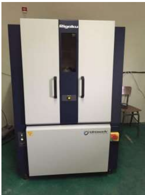
Figure II. 7 : L'appareil de la diffraction des rayons X de type RIGAKU ULTIMA-IV.
