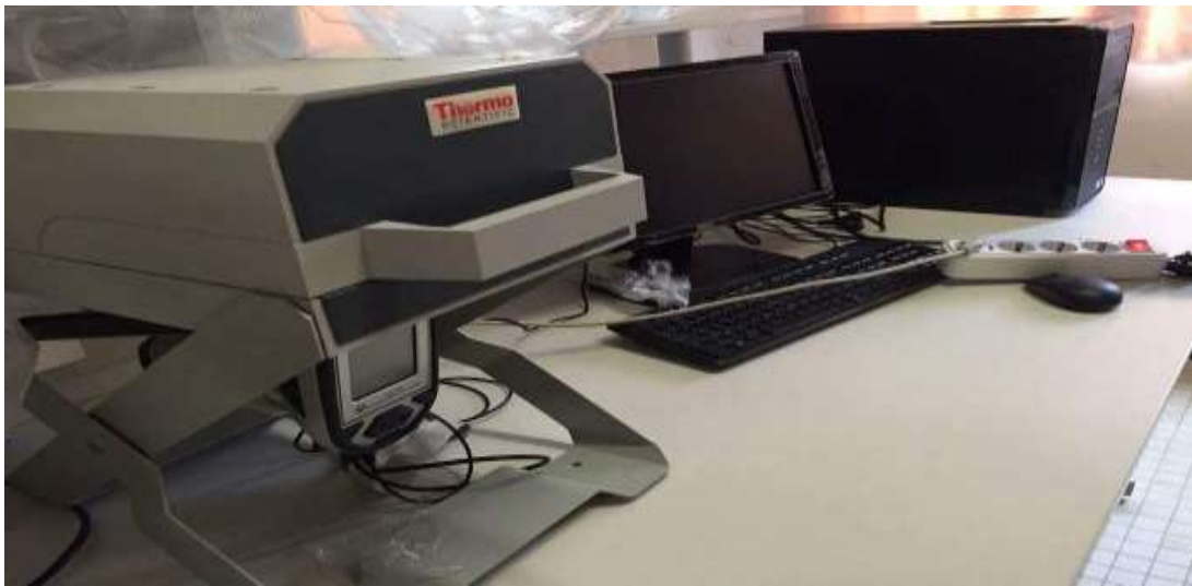
Figure II. 6 : L'appareil XRF de type Thermo scientifique Niton XL3t
