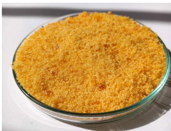
Figure B.1 : Grains du matériau hyperbranché PEIP.
