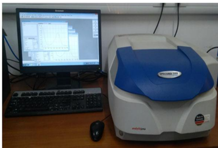
Figure B.3 : spectrophotomètre UV-Visible type (SPECORD 210/plus).
