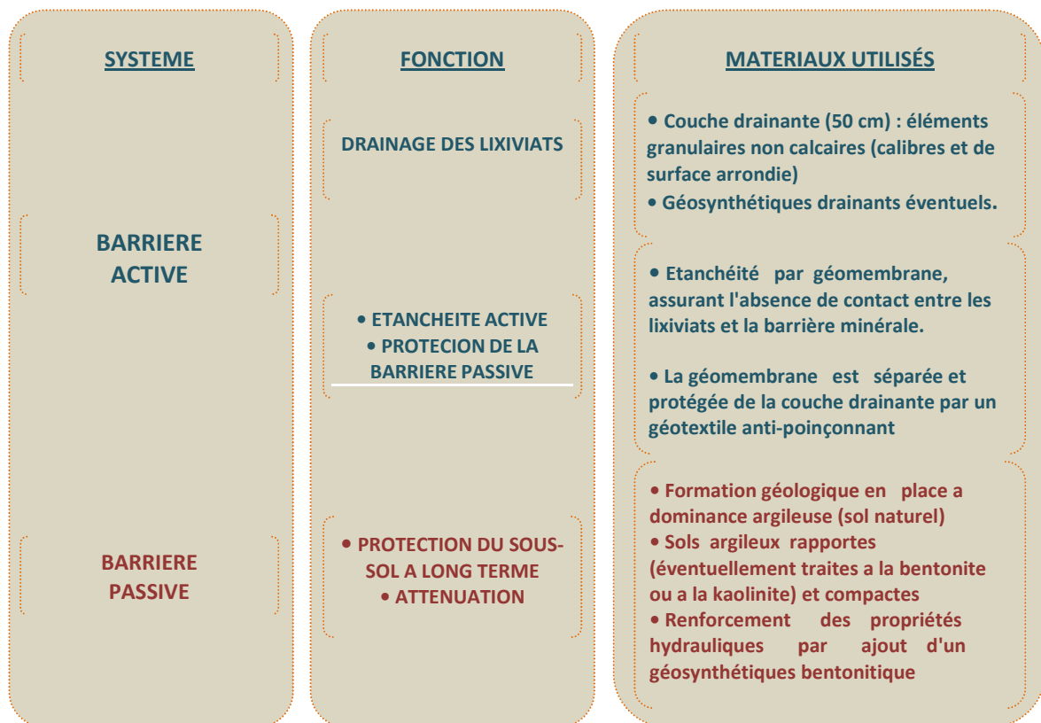
Figure I-6. Diagramme du principe de l'étanchéité composite et des matériaux utilisés.
