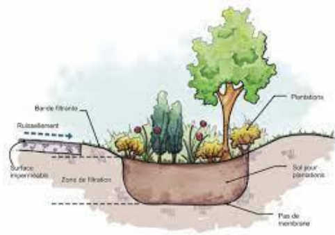
Figure 9 fonctionnement du jardin de pluie
