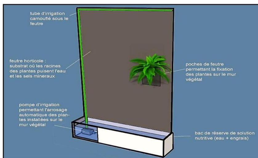
Figure 4: technique d'un mur végétal selon Patric le blanc, source : http://www.naturedesign.fr
