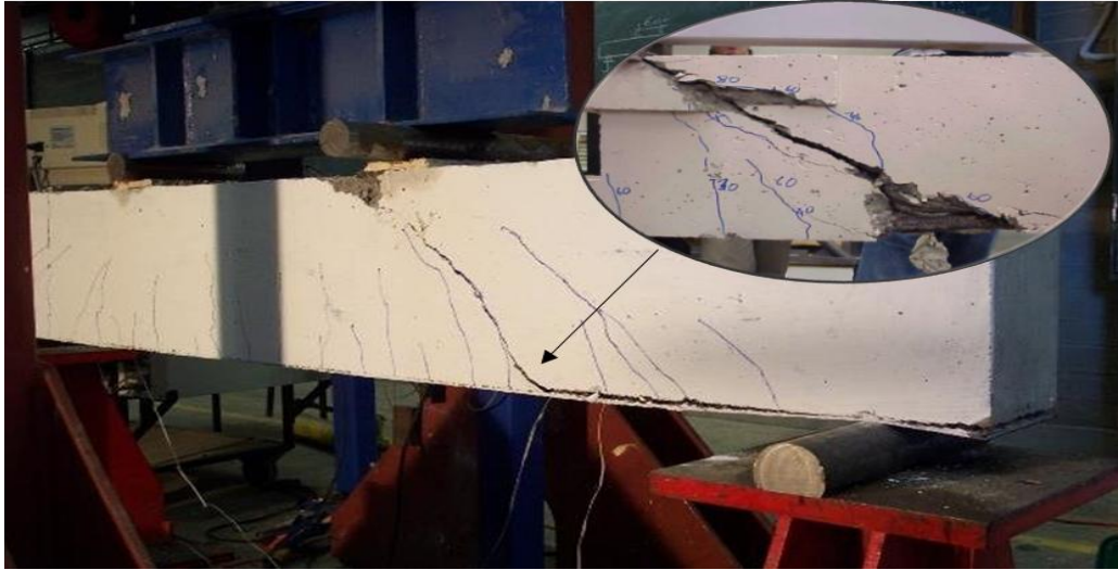
Figure 1.3 : Rupture d'une poutre par cisaillement sous l'effet d'une fissure diagonale d'interface [1].
