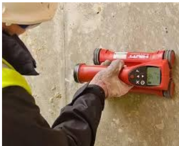
Figures I.14. Exemple d'appareil de détection des armatures.
