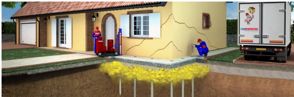
Figures I.5. Exemple de fissures de tassement.
