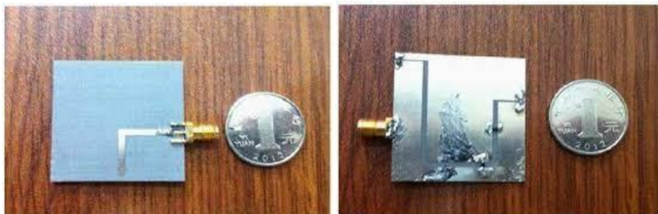
Figure II- 10 : Prototype de l'antenne reconfigurable en fréquence: (a) vue de dessus et (b) vue de dessous [II-14].
