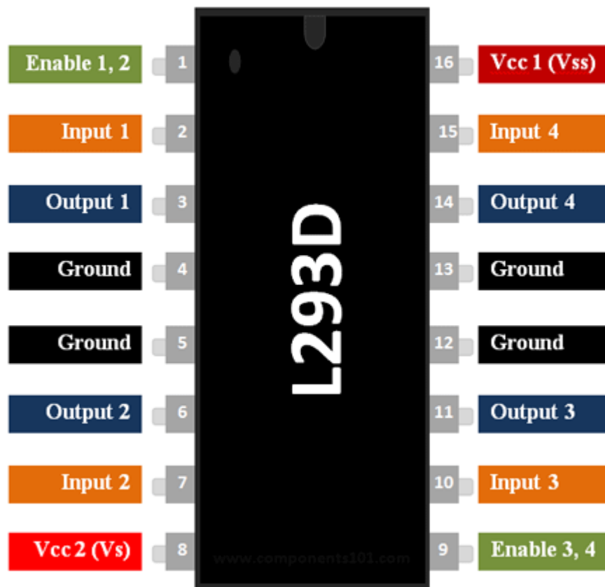
Figure 2.17 Les PIN de Le L293D
