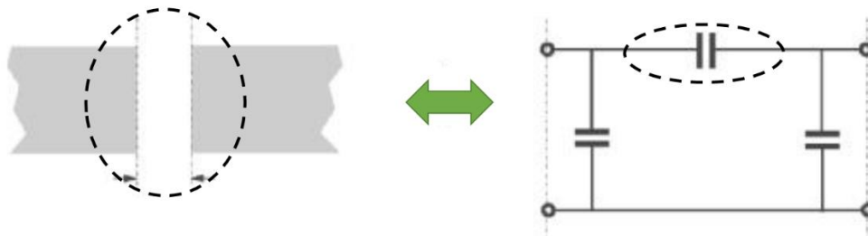
Figure III.5. Réalisation d'une capacité série en ligne micro ruban
