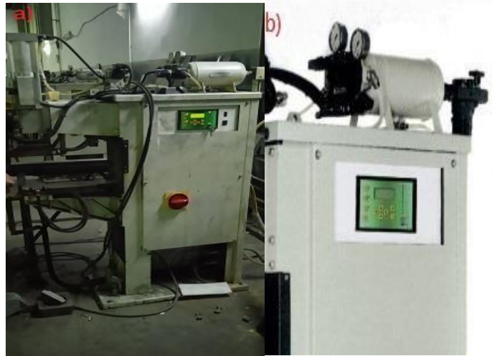
Figure. 7 a) Machine de soudage « TECNA », b) les outils de commande des paramètres de soudage.
