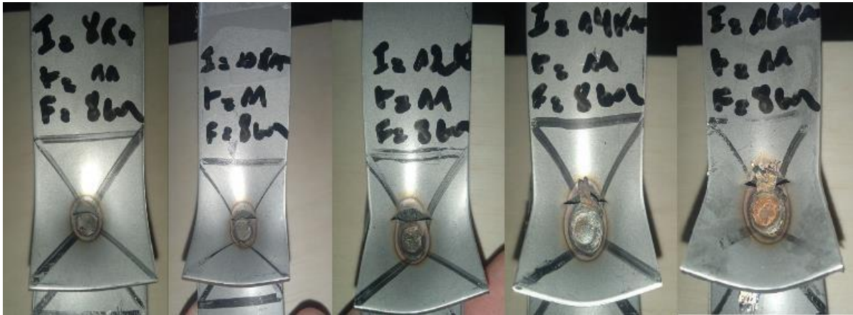
Figure. 21 Déboutonnage de joint par recouvrement pour courant de soudage de 8 KA à 16 KA, temps de soudage 11 cycles et force de soudage 8 bars.
