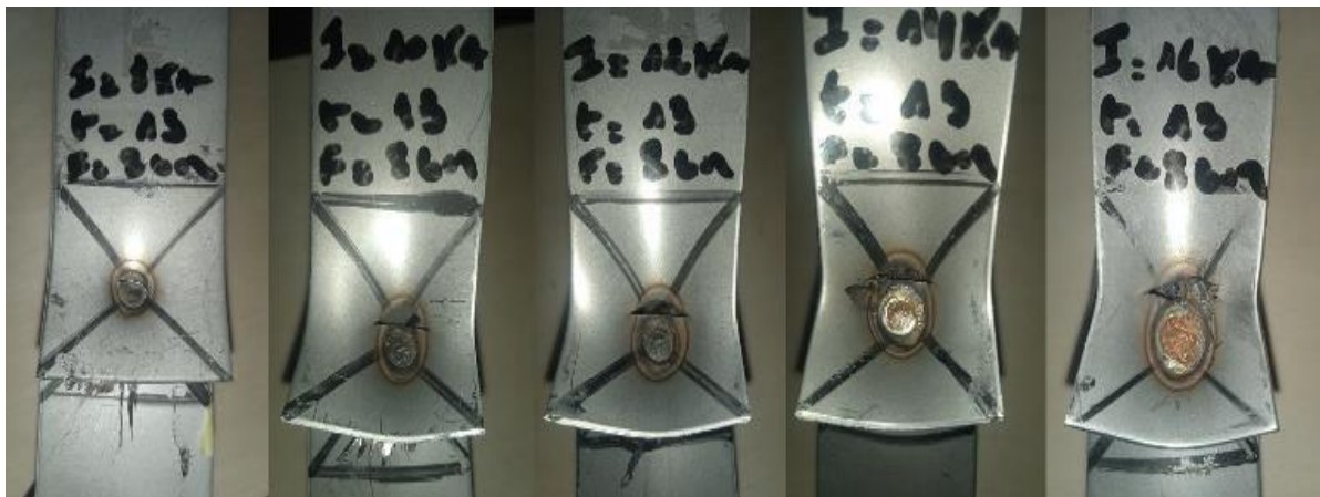
Figure. 22 Déboutonnage de joint par recouvrement pour courant de soudage de 8 KA à 16 KA, temps de soudage 13 cycles et force de soudage 8 bars.
