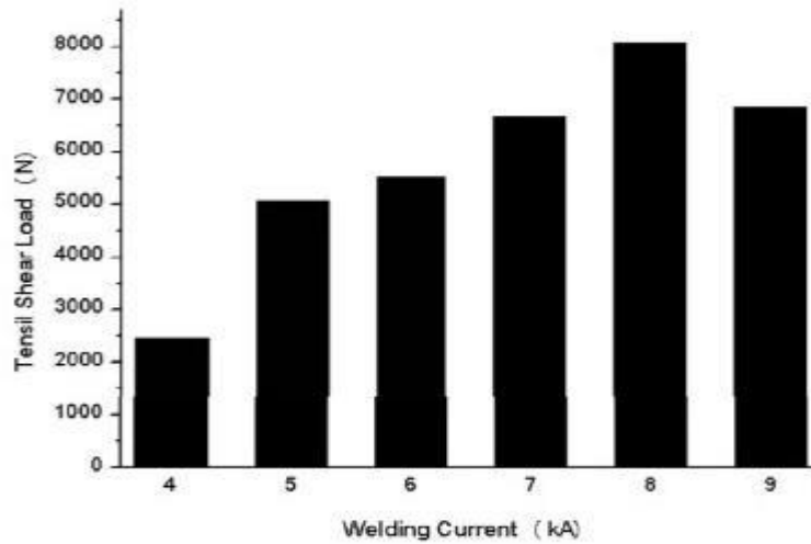
Figure. 12 Effet de courant de soudage sur la charge maximale en cisaillement de l'acier 316L [25].
