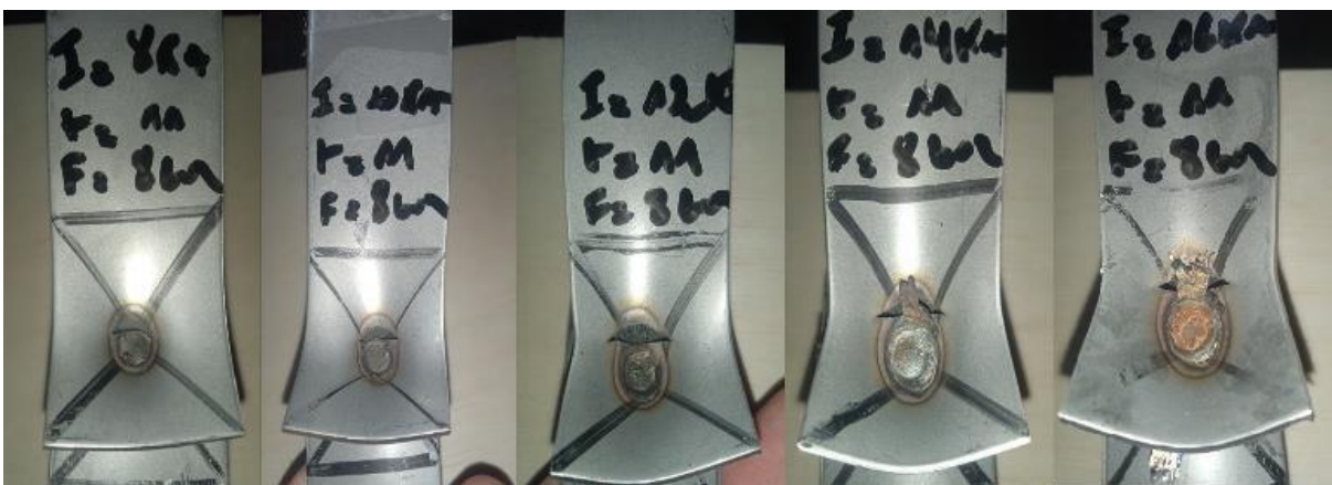
Figure. 20 Déboutonnage de joint par recouvrement pour courant de soudage de 8 KA a 16 KA, temps de soudage 10 cycles et force de soudage 8 bars.
