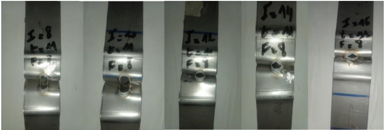
Figure. 18 Déboutonnage de peel joint pour courant de soudage de 8 KA a 16 KA, temps de soudage 11cycles et force de soudage 8 bars.
