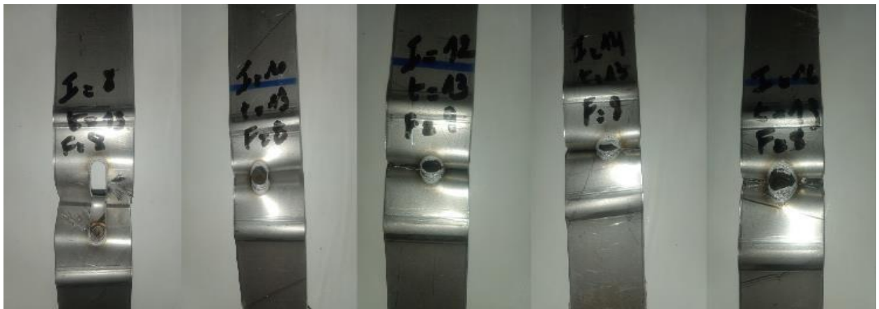
Figure. 19 Déboutonnage de peel joint pour courant de soudage de 8 KA a 16 KA, temps de soudage 13 cycles et force de soudage 8 bars.
