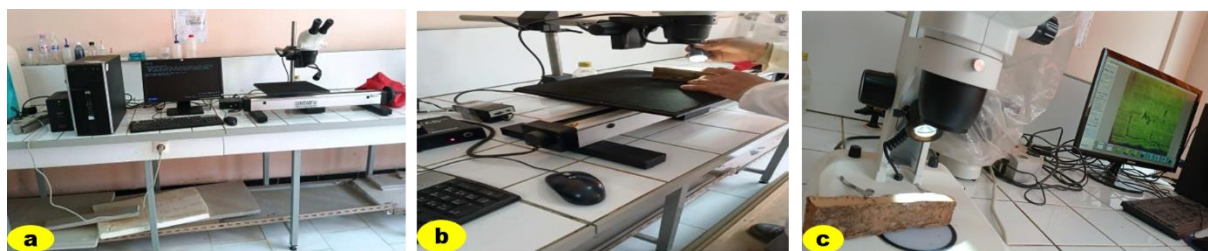
Figure 47- Instruments de mesures des cernes Lintab 6 (a et b) et stéréo microscope binoculaire pour prise de photos des cernes (Photos originales)
