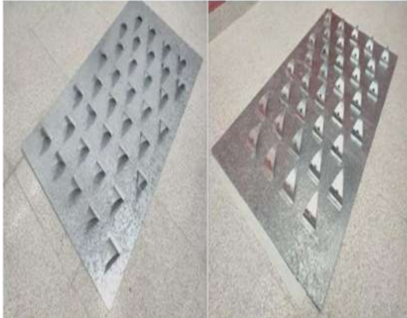
Fig.I. 16: Configuration de l'absorbeur avec des chicanes en forme d'aile delta courbée longitudinalement [16]
