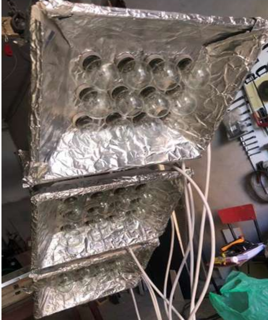
Fig II. 8: Source thermique artificielle
