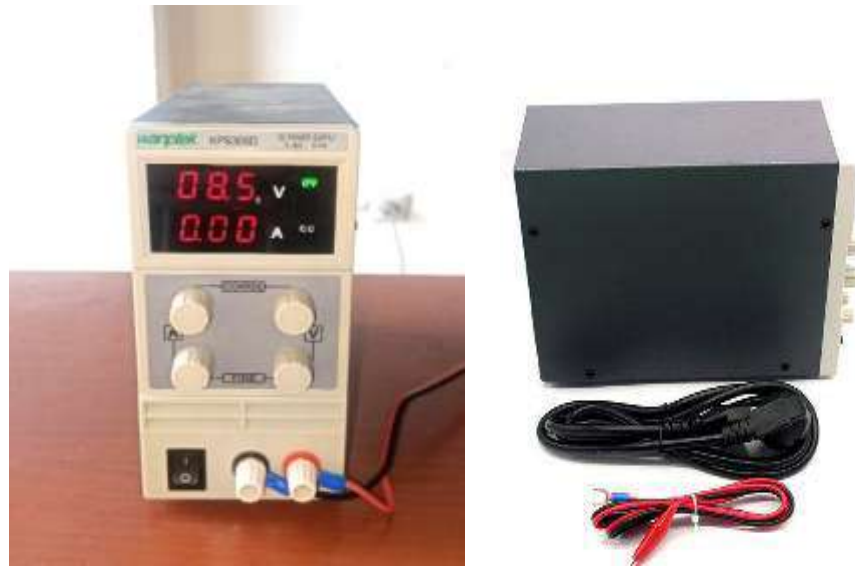
Fig II. 16: Contrôleur de tension et d'ampérage
