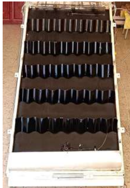
Fig II. 5: Capteur solaire à ail
