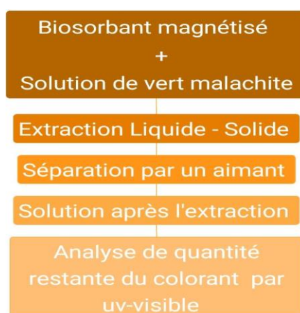
Figure.39. Organigramme représentant l'extraction Liquide -Solide du vert malachite par le biosorbant magnétique.
