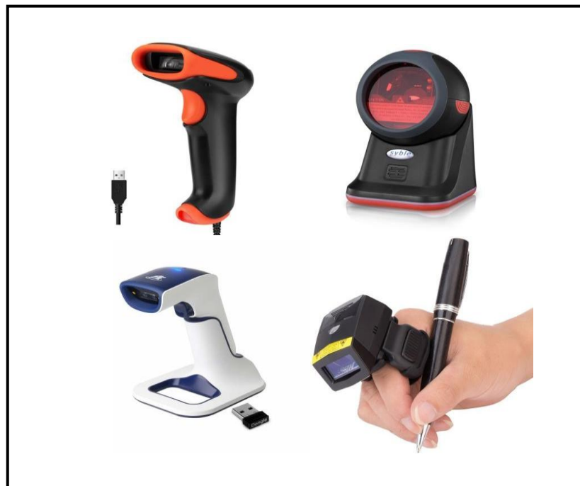
Figure I- 2. Les différents types de lecteurs de code - barres [1].
