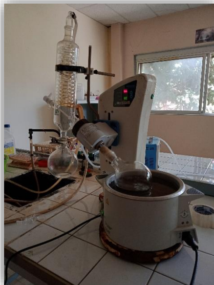
Figure 4 : Evaporation du solvant par un rota vapeur.
