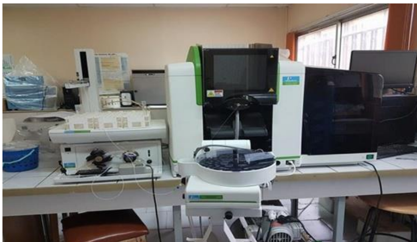
Figure II- 11: Spectrophotomètre d'absorption atomique à flamme type Perkin Elmer Pin AA clé 900 H
