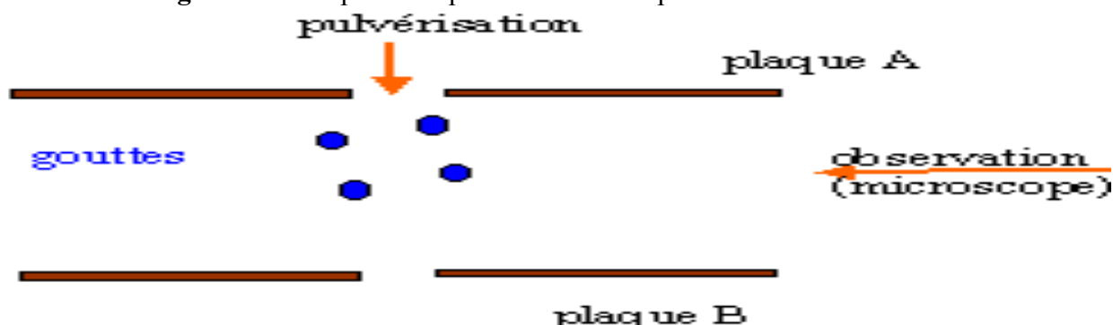
Figure II.2: Dispositif expérimental de l'expérience de Millikan
