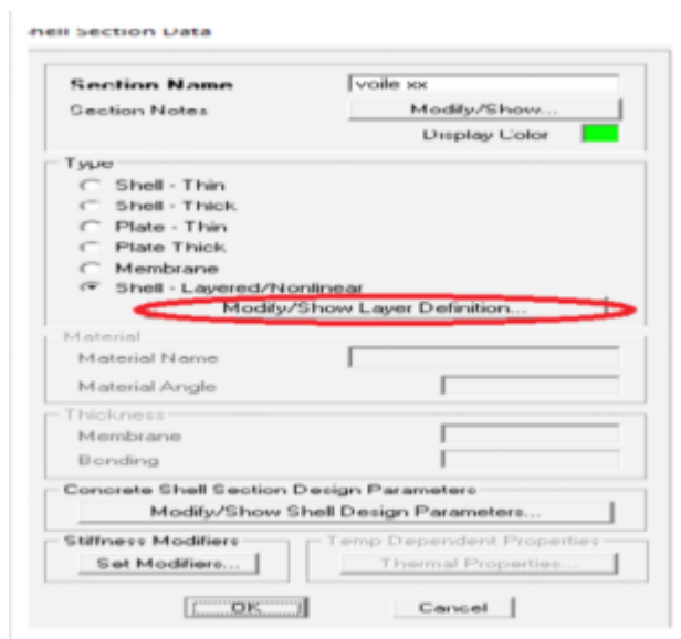
Figure 42: Définition de l'élément non linéaire de type (Shell – Layered / Nonlinéaire)
