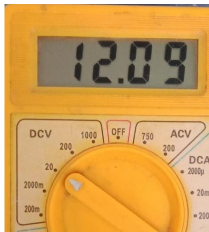
Figure III.41 : Signal et la tension en sortie du régulateur 7812 (12V) (en pratique).
