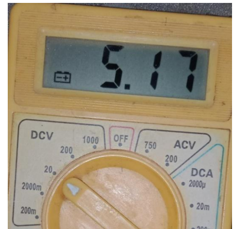
Figure III.44: Signal et la tension en sortie du deuxième étage d'amplification (en pratique).
