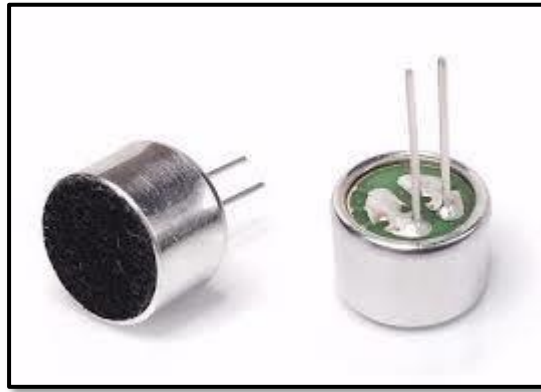
Figure II.5 : Microphone à électret [41].
