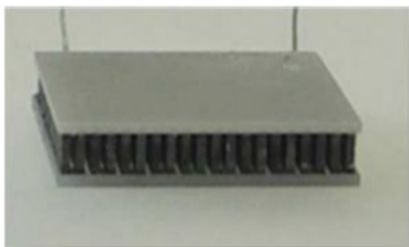
Figure I. 14 : Convertisseur thermoélectrique à base de \text{Bi}_2\text{Te}_3 massif
