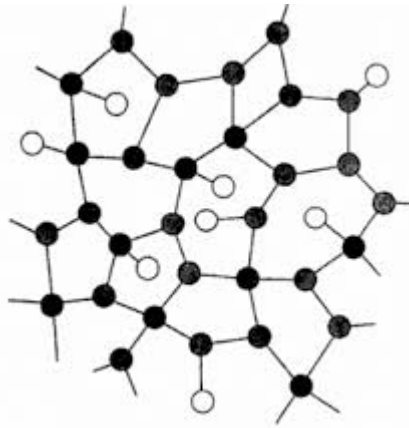
Figure I. 7 : Un schéma de la structure du silicium amorphe hydrogéné (a-Si :H)
