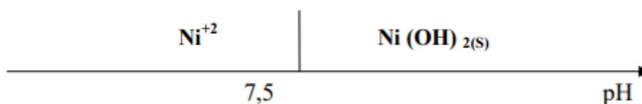
Schéma 10: Formes d'espèces de Ni(II) en fonction du pH
