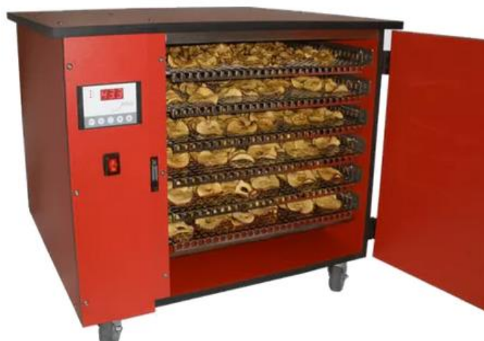
Figure 2.11. Expériences de séchage ont été réalisées à l'aide d'un petit séchoir commercial, (HT mini, Innotech Ingenieurgesellschaft mbH, Altdorf, Allemagne) à un débit d'air constant de 0,6 m/s. [34]
