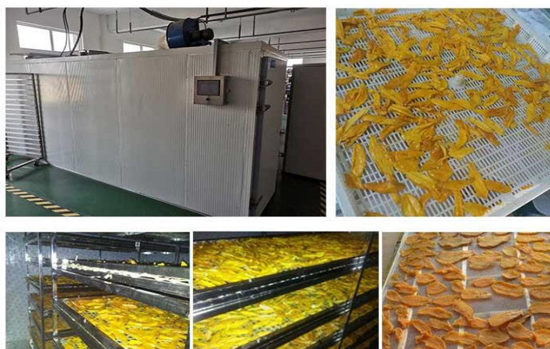
Figure 2.8. Séchage intermittent de la mangue dans un séchoir à convection forcée [30].
