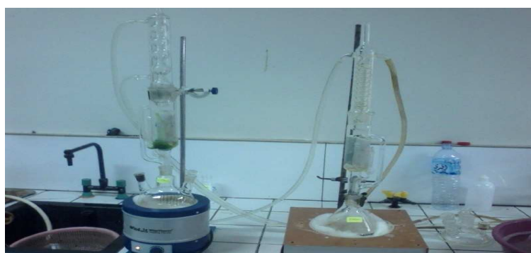
Figure 9 : Montage d'un extracteur de Soxhlet
