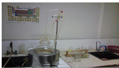
Figure 10: Montage d'hydrodistillation de type Clevenger
