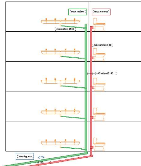
Figure 116: descente principale à côté du poteau
