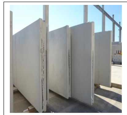
Figure 74: Murs en béton préfabriqués
