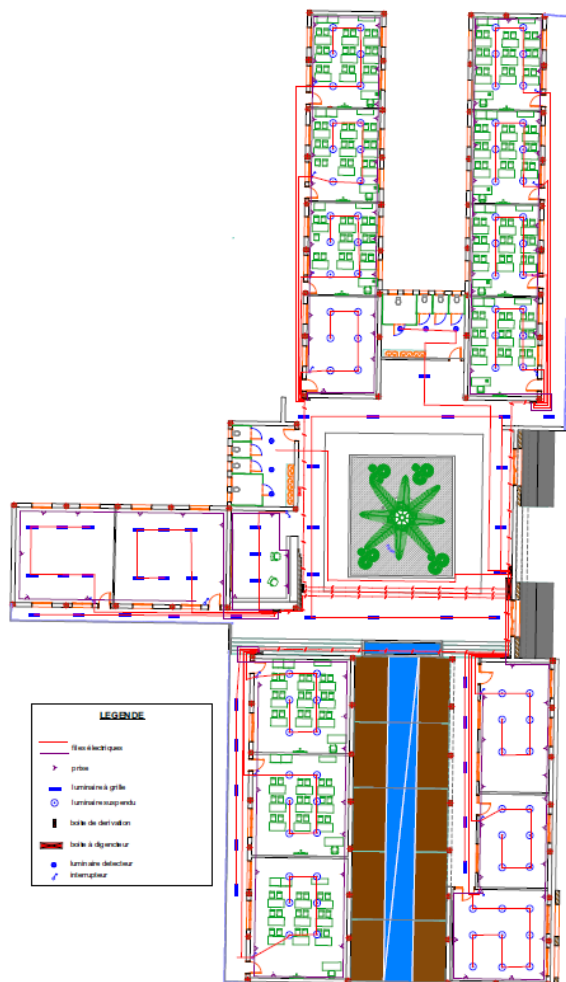
Figure 66: plan électricité bloc des classes de cours 90
